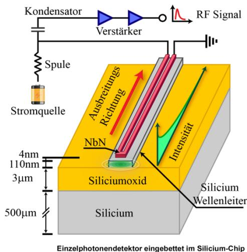
*Fünf Faktoren überzeugen beim neuen Einzelphotonendetektor: 91% Entdeckungseffizienz, direkte Integration auf dem Chip, Zählraten im Gigahertztempo, hohe zeitliche Auflösung und vernachlässigbare Dunkelzählraten; Quelle: KIT/CFN*
